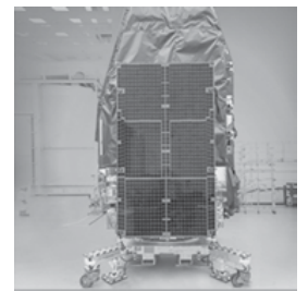
Morelos 3 (2015) • Dimensiones: 41 m x 5 m • Peso: 5.3 toneladas • Lugar de lanzamiento: Cabo Cañaveral, Florida • Cohete que lo lanzó: Atlas-V 421 • Empresa que lo fabricó: Boeing Satellite System International • Empresa que lo lanzó: Lockheed Martin Commercial Launch Services
