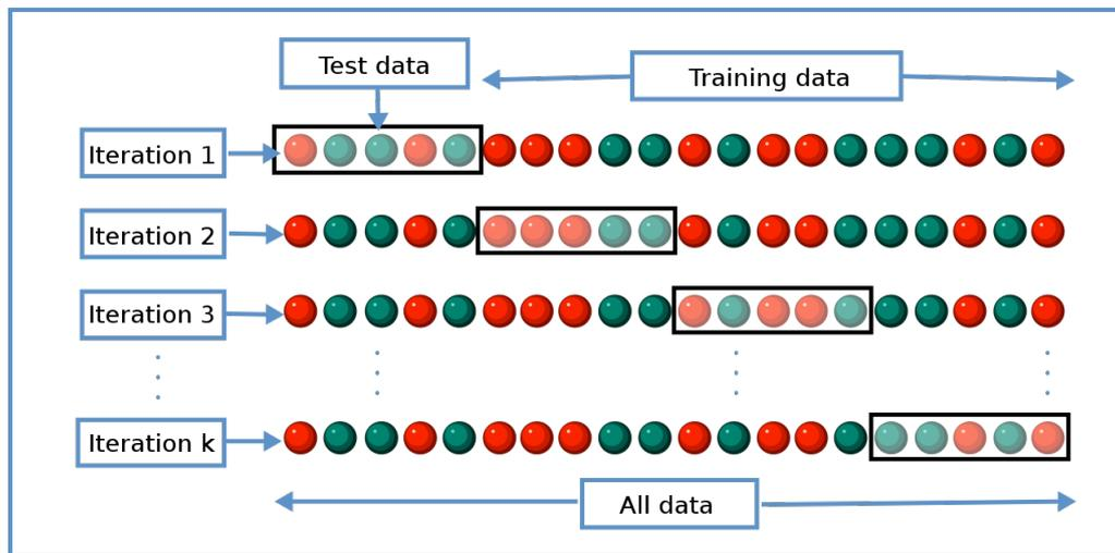
Figura 3.9: Visualización de  $k$ -fold cross validation. El conjunto de datos se mezcla de manera aleatoria y se escoge un grupo de testeo, dejando el resto de los datos como entrenamiento. Las iteraciones sirven para realizar este método de manera definida con tal de minimizar la variación y el bias del modelo. Imagen de [Wikipedia](#).
