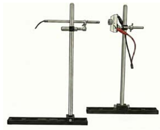
Figura 3.8: Arreglo para la calibración del micrófono. Se colocó el micrófono 46DE sobre un riel. Este se encontraba graduado y dispuesto de tal forma que el 0 del riel colocaba al micrófono inmediatamente en la superficie del emisor. El transductor emisor es el cilindro que se encuentra conectado a la protoboard frente al micrófono, opera a 10V_{rms} y emite a 40 kHz.
