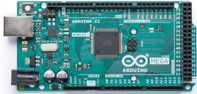
Figura 2.6 Arduino MEGA
