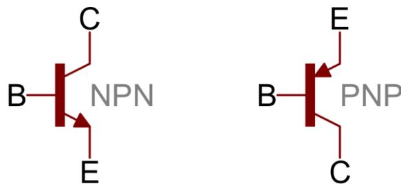
Figura 2.5 Transistor NPN (izquierda) y PNP (derecha)
