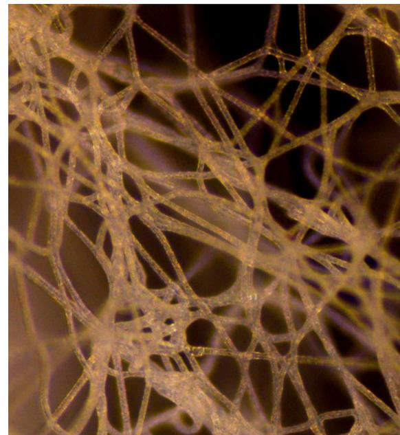
Imagen de membrana polimérica obtenida por electrohilado. Por medio de esta técnica se pueden generar hilos de tamaños de nanómetros a micrómetros. Estos materiales pueden ser utilizados como filtros, membranas para liberación controlada de fármacos y aplicaciones de Ingeniería de tejidos, entre otras. El tratamiento de plasma puede ayudar a modular la mojabilidad de las membranas, dependiendo de la aplicación que se desee dar a las mismas, así como mejorar sus propiedades mecánicas.
