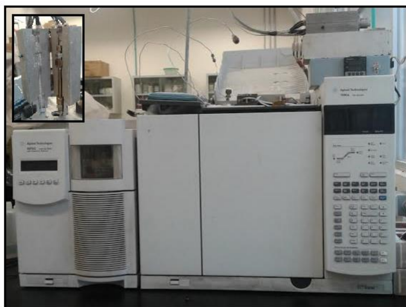
Figura 5. 8: Cromatógrafo Agilent modelo 7890AGC. Recuadro interior termodesorción de la muestra.
