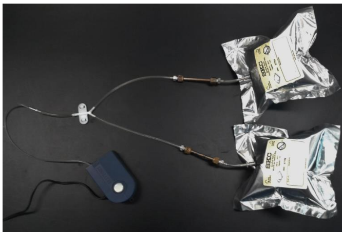
Figura 5. 7: Preconcentración de las muestras de aliento en cartuchos adsorbedores.
