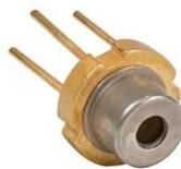
Figura 16. Diodo láser.
