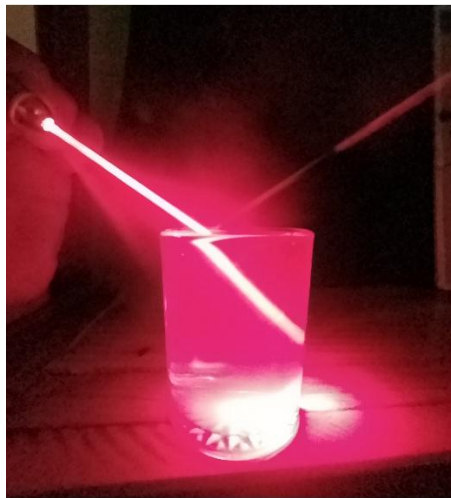
Fig.1.5 a) Corte transversal que muestra a un rayo de luz I proveniente del medio A incidiendo en la superficie del medio B en el punto X. Una parte del rayo se refleja R y otra parte se transmite T. La línea N es perpendicular a la interfase y se introduce como ayuda para el análisis geométrico. b) Fotografía de un haz láser incidiendo sobre la superficie de agua.
