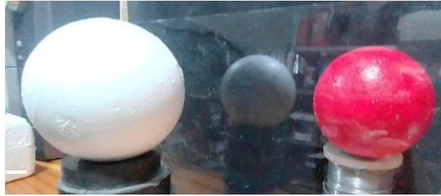
Fig.1.4 La esfera roja se encuentra al otro lado del vidrio y se observa por la transmisión de la luz. La blanca se encuentra del lado del observador y su imagen se observa por la reflexión en el vidrio.
