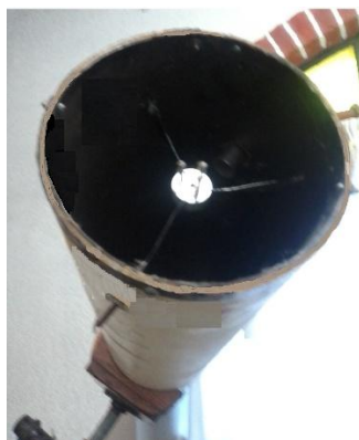
Fig. 3.6 Ubicación de la araña en el tubo
