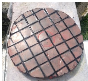
Fig. 2.11 Herramienta a la que se le han hecho canales en cuadrícula
