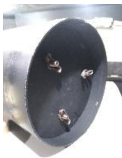
Fig. 3.2 Posición del soporte del espejo primario dentro del tubo de pvc
