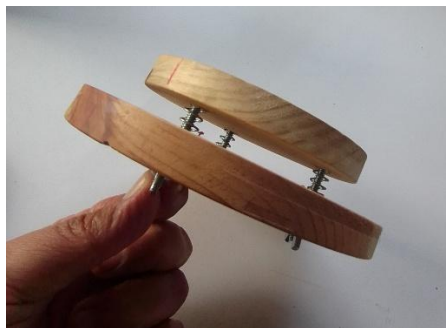
Fig. 3.1 a ->g Soportes para el espejo primario. Ver texto.
