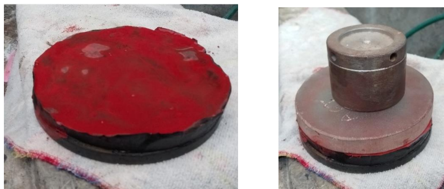
Fig. 10 a) Pulidor sobre la herramienta y b) Montaje final
