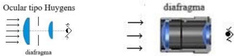
Fig. 4.2 Esquema de ocular del tipo Huygens
