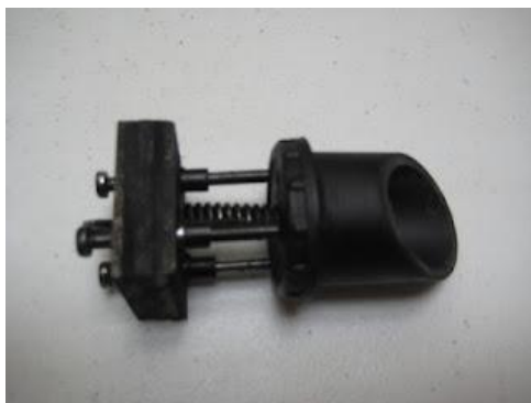
Fig. 3.4 Configuración del soporte del secundario (araña).
