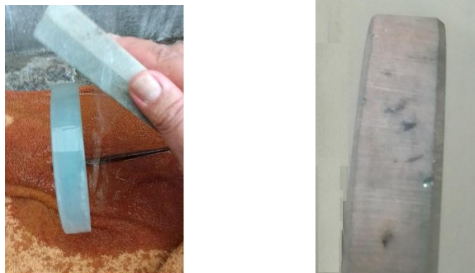
Fig. 2.1 biselado del vidrio. A la izquierda una imagen del proceso y a la derecha ya finalizado. Hacerlo en ambas caras.
