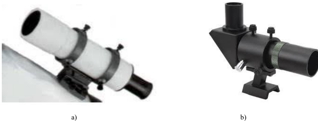
Fig. 6.1 Dos buscadores típicos. En a) la visión del ocular es paralela al eje del telescopio. En b) un prisma permite la búsqueda perpendicular al eje del telescopio
