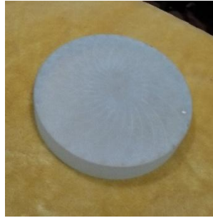
Fig. 2.4 Aplicación del abrasivo 120 en la cara “mala” del vidrio del espejo primario
