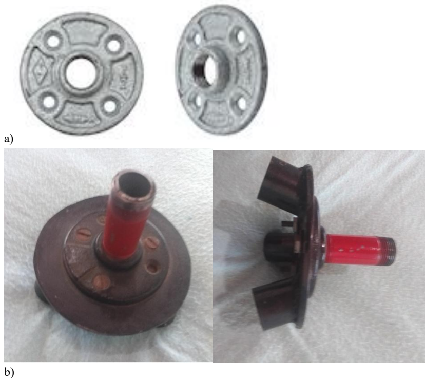
Fig. 5.6 a) Bridas, b) placa circular con brida atornillada y coples soldados
