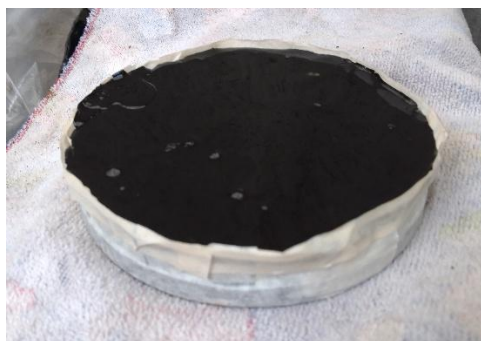
Fig. 2.9 Se muestra el chapopote vertido sobre la herramienta. El máximo se encuentra cerca de la orilla superior de la cinta de masking Tape.
