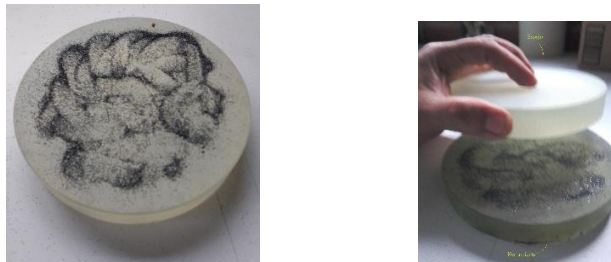
Figura 2.5. Disposición de los vidrios y abrasivo para iniciar el desbaste
