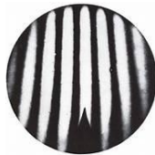
Fig. 2.18 Planicidad relativa entre dos superficies
