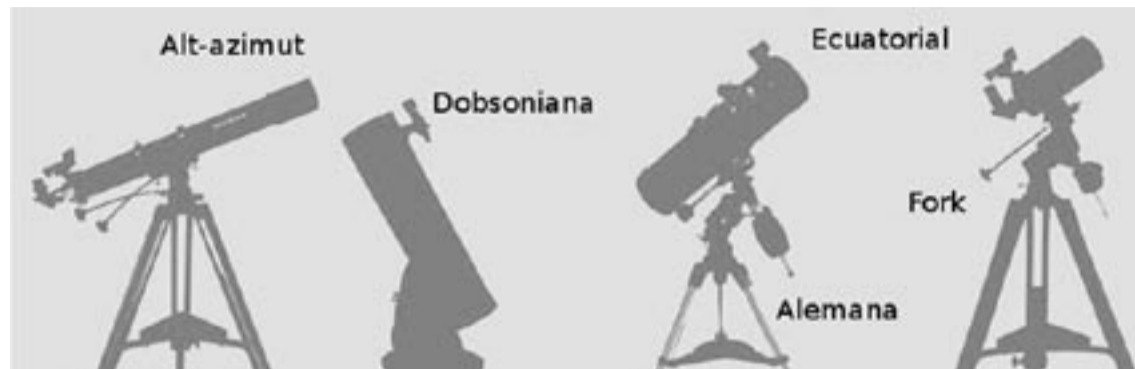
Ilustración 1: Tipos de montura para telescopios: La alt-azimut se divide a su vez en Dobsoniana y la clásica alt-azimut. La ecuatorial se divide en la clásica montura alemana y la fork.
